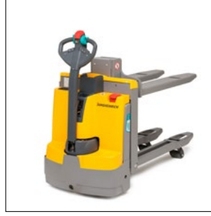
EMD 115i'nin kısa kaldırma mastı ile 690 mm'lik bir yüksekliğe kadar ergonomik sipariş toplama
