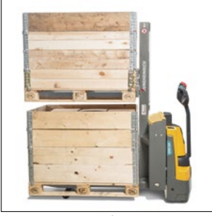
Çift katlı kullanım: İki paleti üst üste alabilme
