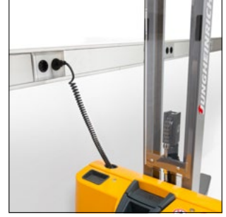
Entegre şarj cihazı sayesinde her 230 V elektrik prizinde kolayca şarj etme
